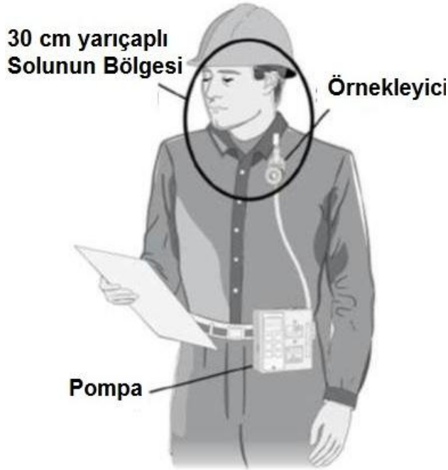
Şekil 22- Gaz, toz, duman- kişisel maruziyet ölçüm düzeneği
