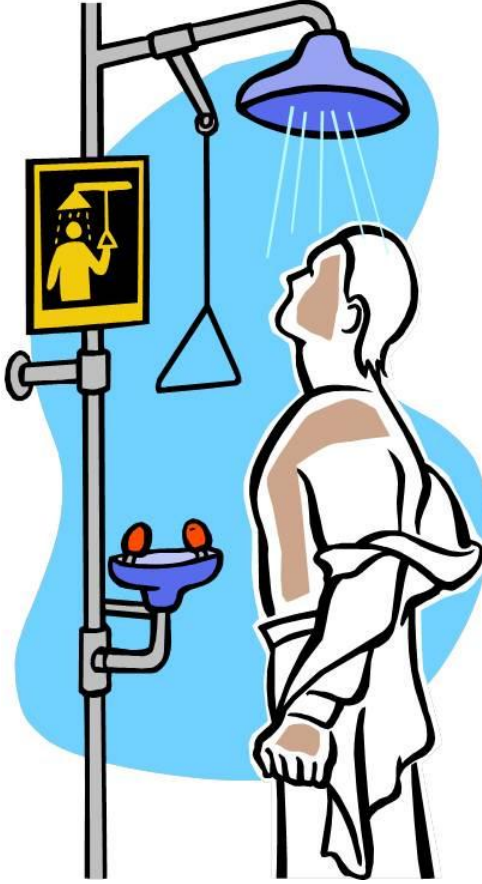
Şekil 38 – Acil duş ve acil göz duşu (Göze kaçan, cilde bulaşan kimyasal madde MGBF belirtildiği şekilde temiz su ile iyice yıkanmalıdır).
