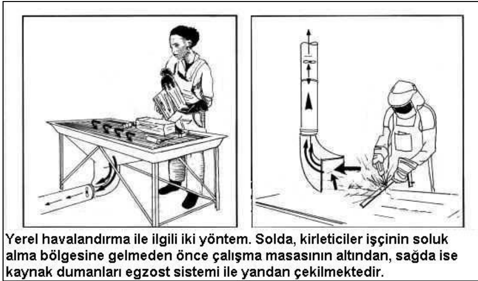
Şekil 34- Havadan ağır olan etkenler için yerel havalandırma .
