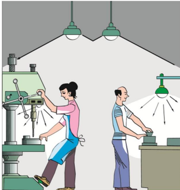
Şekil 32 – Uygun olmayan ve olan armatür yerleri
