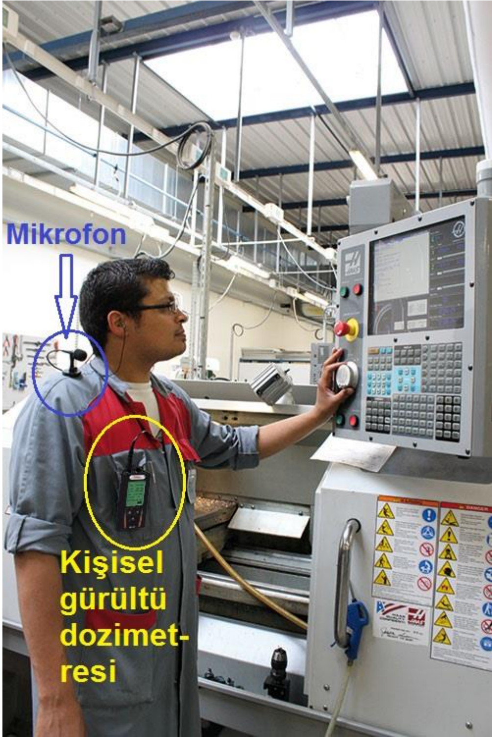
Resim :3 İşçi üzerine bir kişisel gürültü dozimetresi takılmıştır. Dozimetrenin mikrofonu olabildiğince kulağa yakın yerleştirilmiştir.
