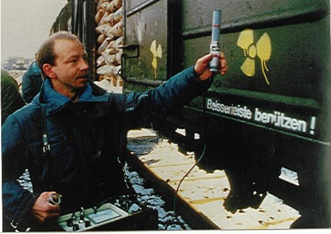
Resim 27 - Bir çevrede radyoaktiviteyi ölçmek için Gayger Sayacı ya da onun gibi bir alet kullanılabilir.
